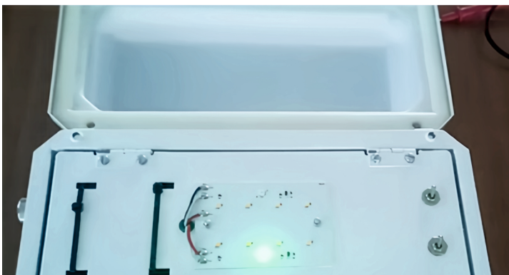
Блок аварийного питания встроенный в светильник
